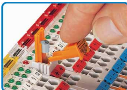
Extracteur pivotant pour l'échange rapide du fusible. Attention : n'utiliser que des fusibles certifiés selon UL
