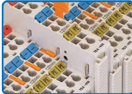
Connexion sûre et automatique par des contacts étamés, autonettoyants et coulissants, avec contact de terre avancé (séries 750 et 753)
