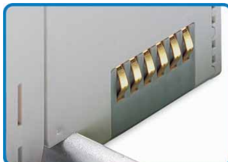
Connexion sûre et automatique par des contacts dorés, autonettoyants et coulissants à haute sécurité de contact (séries 750 et 753)
