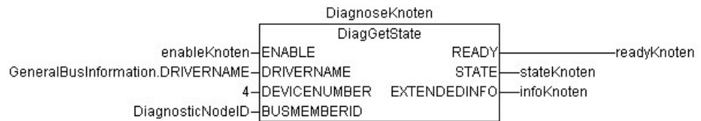
Abbildung 95: Funktionsbaustein DiagGetState() in FUP
