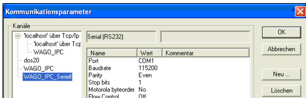
Abbildung 59: Anlegen einer Kommunikationsverbindung (RS-232) 2
