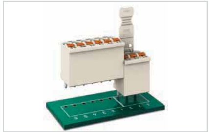
Leiterplatte entsprechend dem Aufdruck mit Federleisten bestücken und einlöten.
