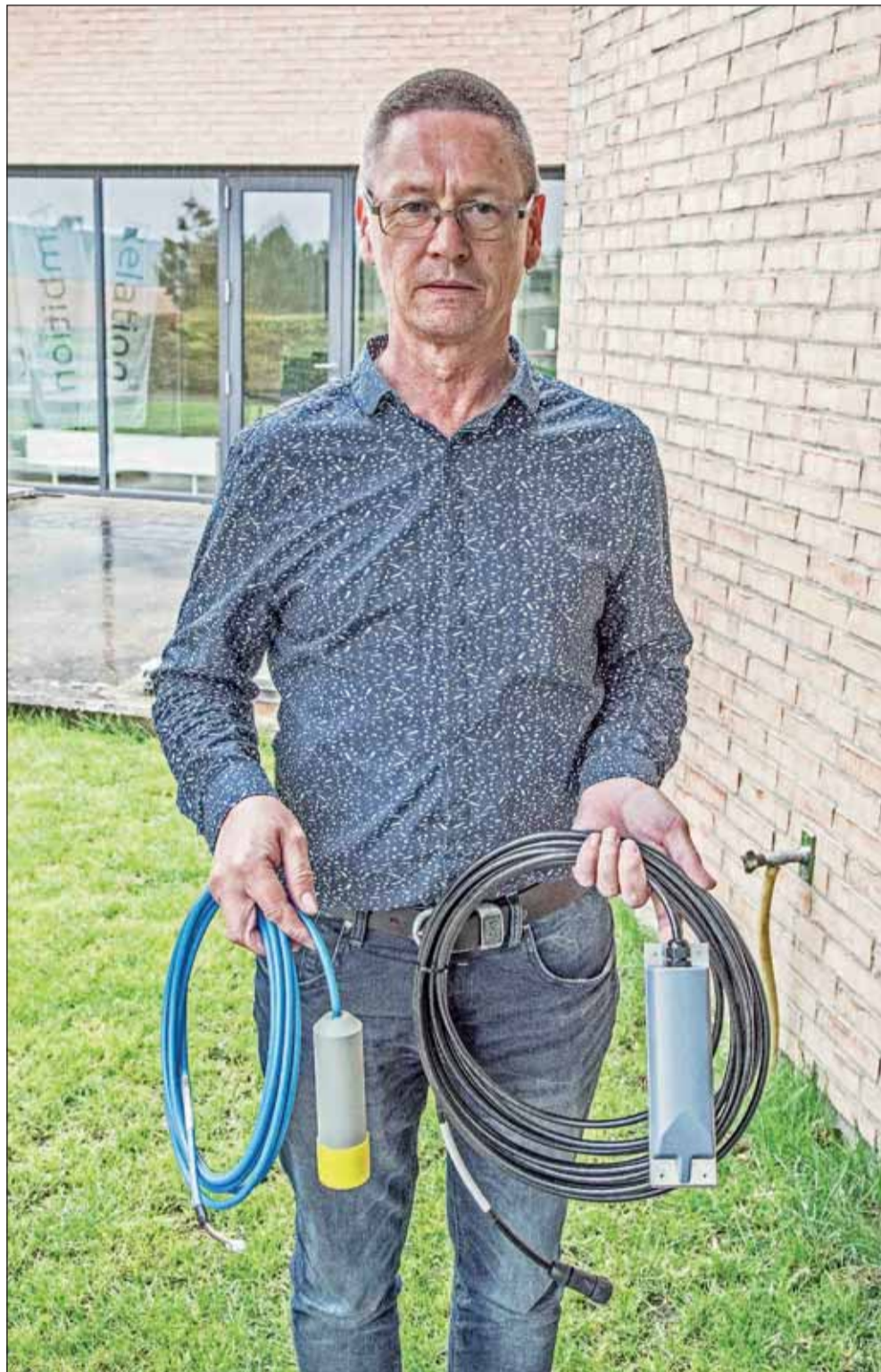
Projektleder Jørgen Skaftø, Kalundborg Forsyning A/S, viser de to sensorer, der registrerer niveau og hastighed. Til venstre niveausensoren og til højre Beluga ultralydsdopplersensoren.
