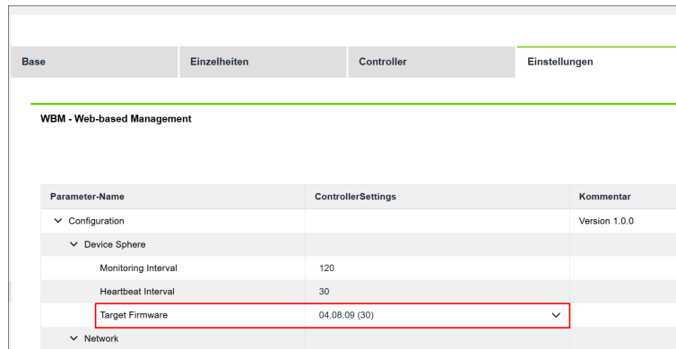
Abbildung 49: Firmwareversion eines Controllers wird über ein Drop-down-Menü verändert
