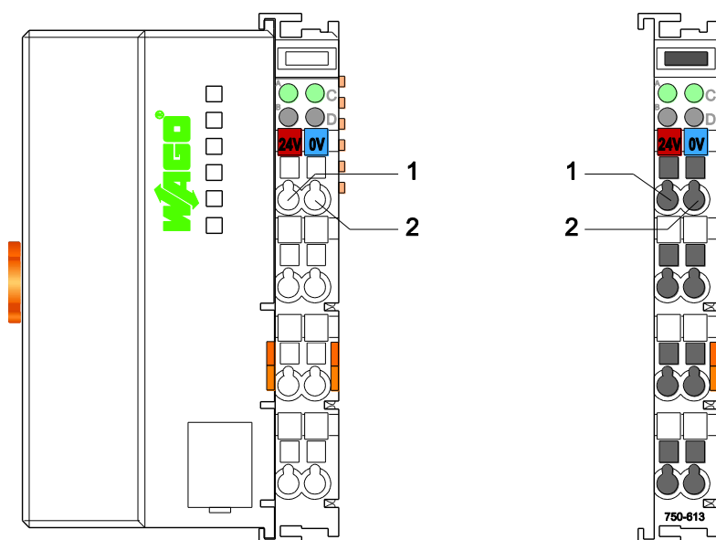
Ilustracja 5: Zasilanie systemowe przez interfejs/sterownik sieciowy (po lewej) i przez moduł zasilający (po prawej)
