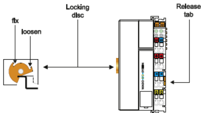
Ilustracja 29: Blokada ryglująca na standardowym interfejsie/sterowniku sieciowym (przykład)
