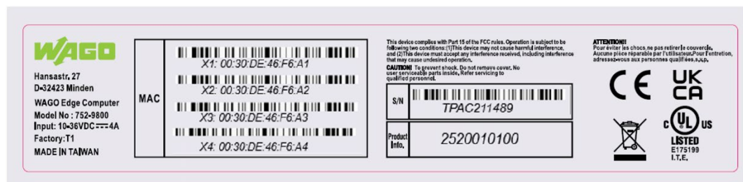
Ilustracja 2: Tabliczka znamionowa (przykład)
