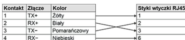
Ilustracja 8: Rozmieszczenie pinów RJ45
