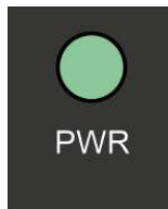
Fig. 4: LED d'état de la tension d'alimentation
