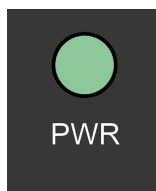
Fig. 6: LED d'état de la tension d'alimentation
