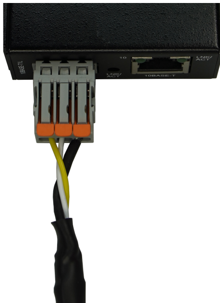
Fig. 11: Torsadage de la ligne de données
