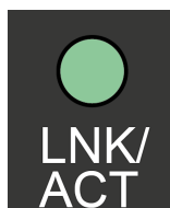
Fig. 8: LED d'état du port Single Pair Ethernet
