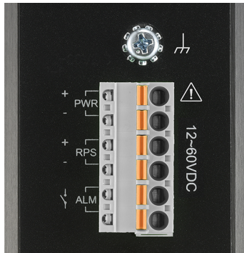
Abbildung 4: Anschluss Spannungsversorgung (PWR/RPS)
