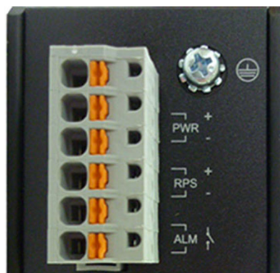
Abbildung 4: Anschluss Spannungsversorgung (PWR/RPS)
