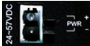
Abbildung 4: Anschluss Spannungsversorgung (PWR)
