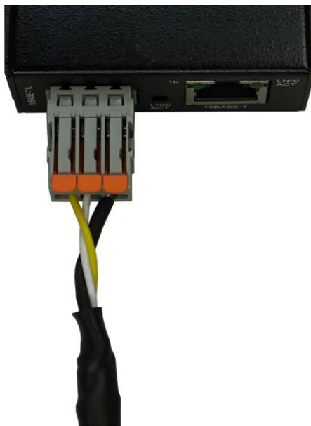
Ilustracja 10: Skręcanie przewodu komunikacyjnego
